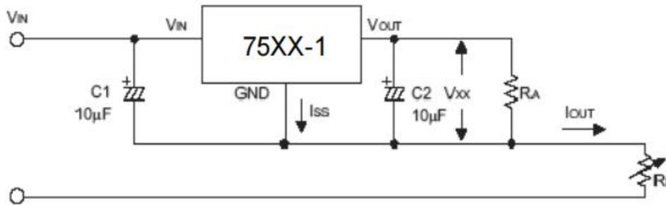
Dual Output Circuit 双端输出电路
