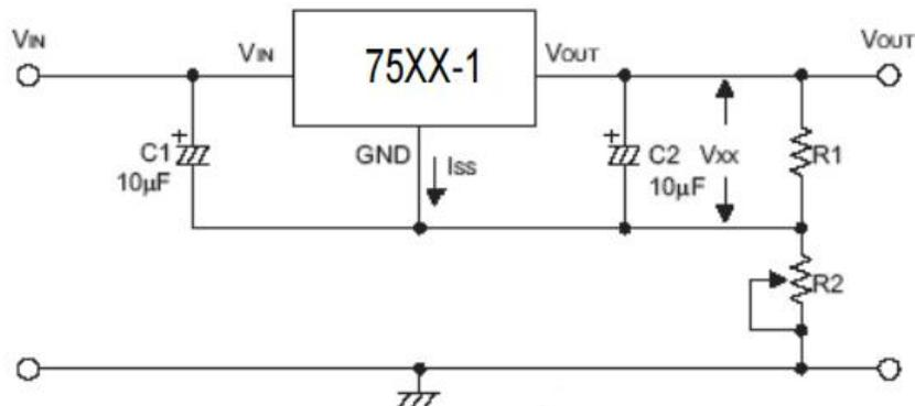
High Output Voltage Circuit 高输出电压电路  $V_{OUT}=V_{XX}+VD1$
